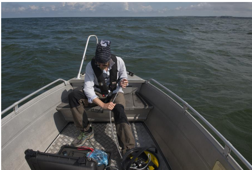
Figur 1. Utföraren övervakar inspelningen på en skärm i båten och justerar kontinuerligt avståndet till botten genom att släppa ut eller dra in kabeln.
