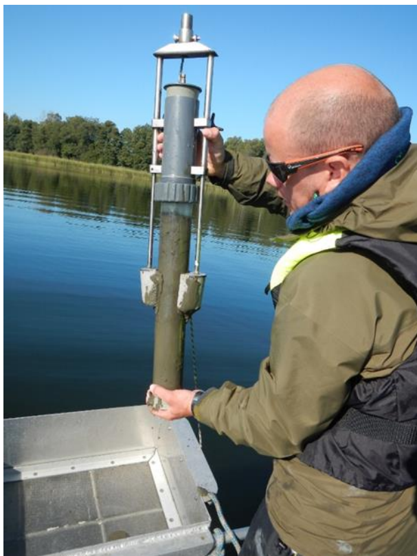
Figur 3. Med hjälp av en Willnerhämtare togs sedimentprov som sållades genom 1 mm maskstorlek för analys av bottenfauna.
