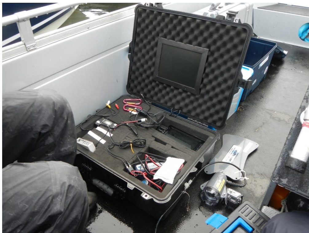
Figur 2. Kameran hängs ned under båten och bilden visas på en skärm samt sparas på en hårddisk.
