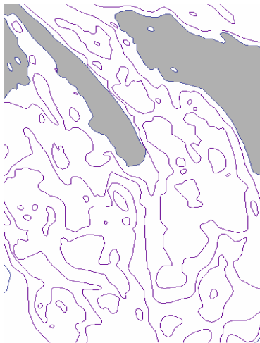
Figure W. Höjdkurvor med 5 m ekvidistans användes för modellen.
