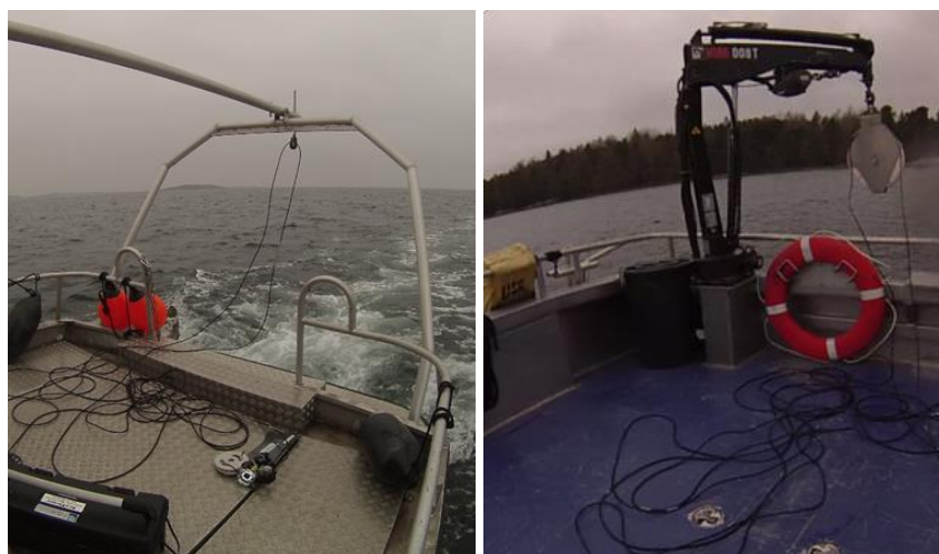
Figur 3 Undervattenskameran släpas efter båten och kan positioneras mot sjömätningsdata i en efterbearbetningsprocess. Den vänstra bilden visar fästpunkt för kamera på M/V Nils och den högra bilden visar fästpunkt för kameran på M/V Lode. Fotograf Trolle Carlsson, AquaBiota Water Research.
