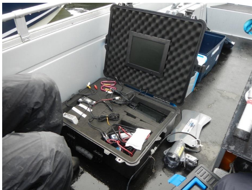
Figur 2. Kameran hängs ned under båten och bilden visas på en skärm. Filmen inspelas i HD-format med hjälp av en go pro-kamera som fästs ovanpå dropvideokameran. Filmerna analyseras i kontorsmiljö.
